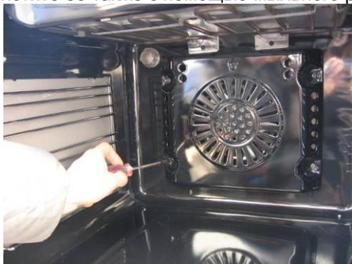
Снимите вентиляционную решетку, ослабив шурупы.
